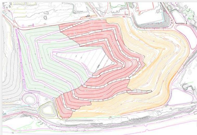
Figura 10 Morfología final del vertedero con ampliación de la celda 4.
