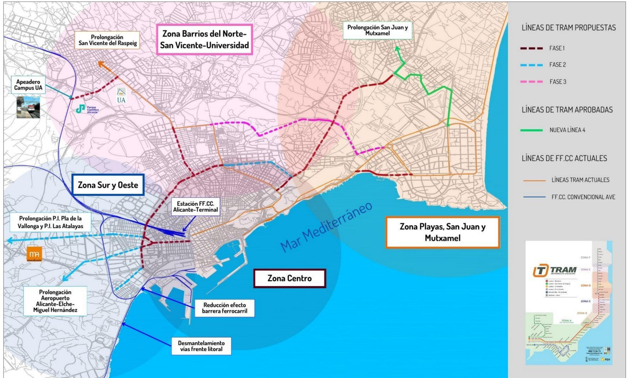
Figura 12. Zonas de Alicante generadoras/atractoras de tráfico más las Líneas de TRAM actuales y propuestas. Elaboración propia.
