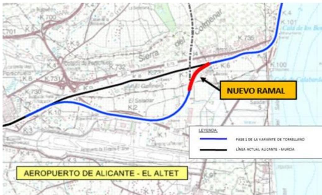
**Figura 84.** Trazado Fase I de la Variante de Torrellano, conexión con el aeropuerto de Alicante-Elche. **Fuente:** Estudio informativo del ramal de conexión entre la línea actual Alicante-Murcia y la variante de acceso al aeropuerto de Alicante.
