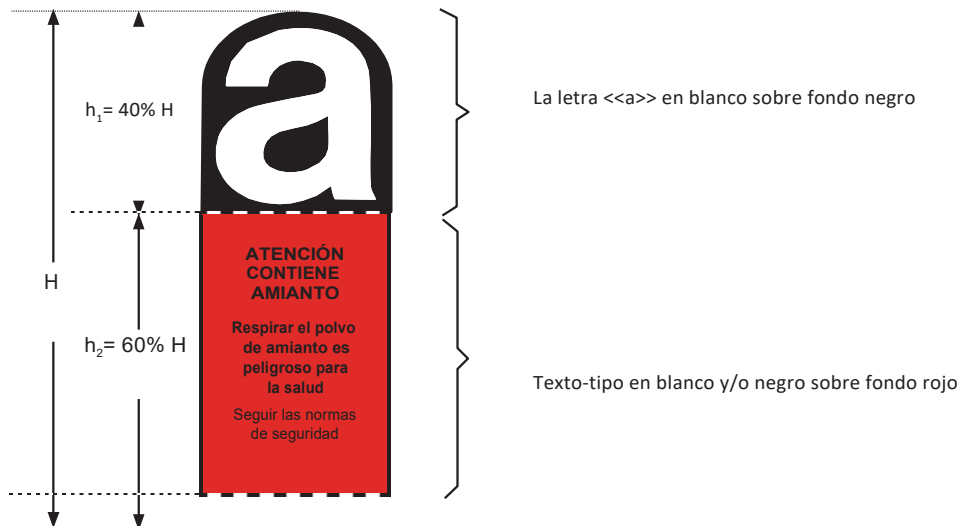
Etiqueta reglamentaria de identificación de materiales con amianto.
