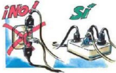
**14** Cuando un receptor (electrodoméstico, maquinaria, etc.) le dé "calambre" es porque hay derivación de corriente de los hilos conductores o en algún elemento metálico del electrodoméstico. Normalmente se Dispara el Diferencial. Localizar el aparato o parte de la instalación donde se produce y aislar debidamente al contacto con la parte metálica. Para ello debe llamar al Instalador Autorizado para que localice la fuga.
