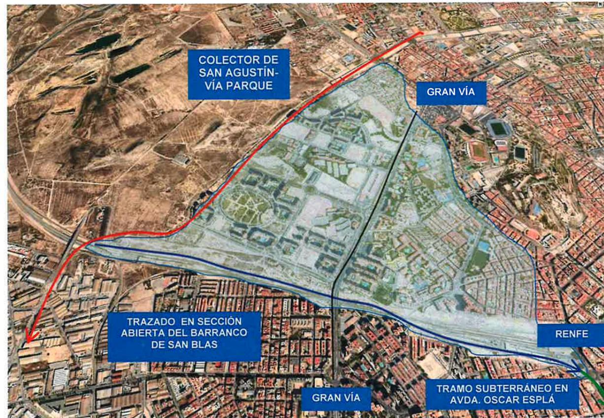
Por otra parte, dichas obras de encauzamiento ejecutadas consistieron en la ejecución de un canal de sección abierta capaz para un caudal máximo de 46,6 m<sup>3</sup>/s, que se corresponde con un período de retorno de 100 años, hasta el punto de conexión con el colector de Oscar Esplá en la esquina de las calles Francisco Candela y Alcalde Ramón Hernández.
