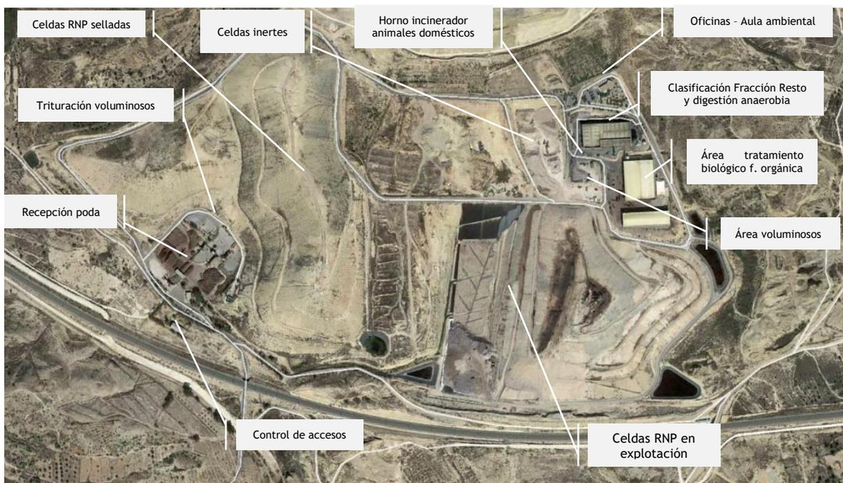
Ilustración 2. Áreas tratamiento CETRA. Instalación de valorización y eliminación de residuos
