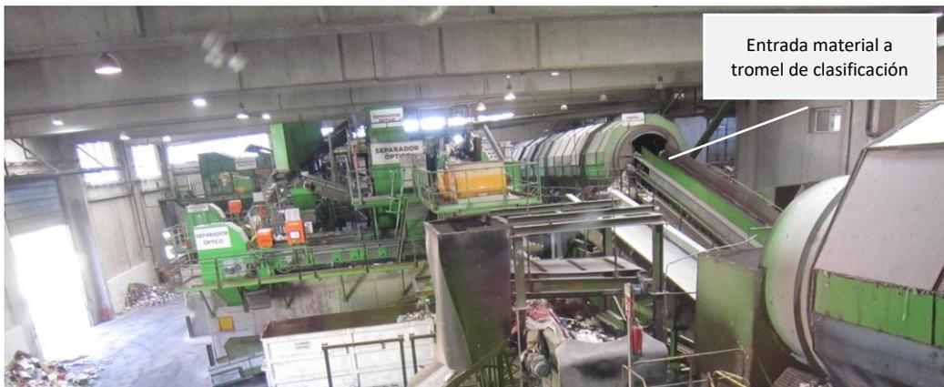
**Fotografía 9.** Vista línea de clasificación Planta e indicación ubicación tromel de clasificación
