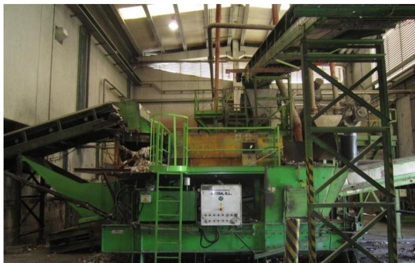
**Fotografía 20.** Vista prensa metales no férricos y área alimentación a digestión anaerobia
