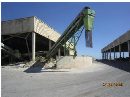
**Fotografía 34.** Equipo descarga material afinado
