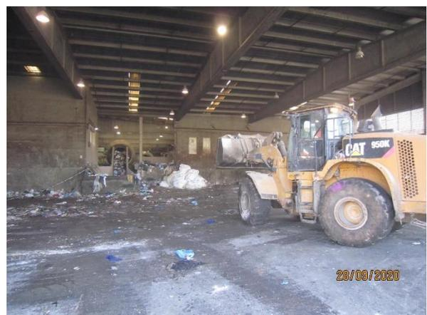
**Fotografía 4.** Operación de carga al alimentador
