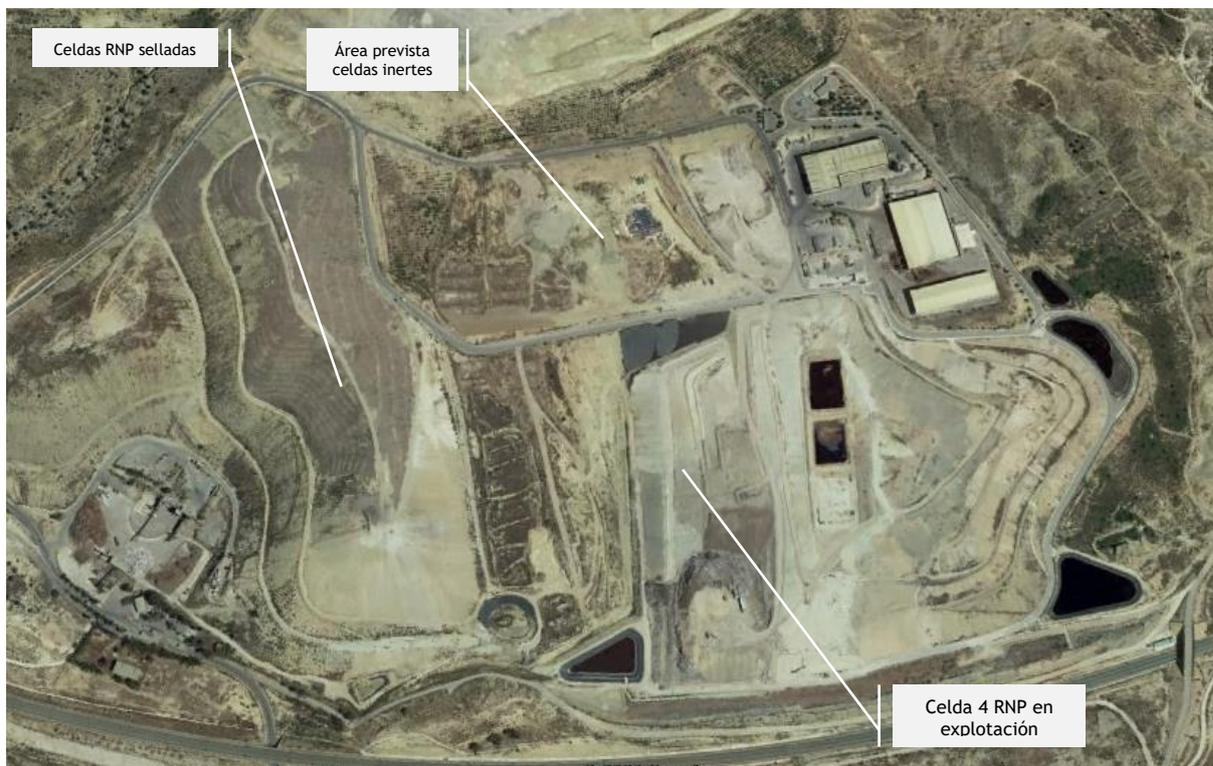
**Ilustración 6. Instalaciones de eliminación de residuos RNP e inertes del CETRA**
