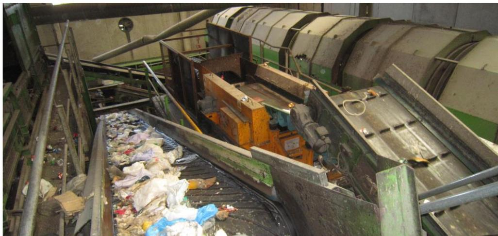
**Fotografía 10.** Vista tromel de clasificación desde plataforma de separación automática
