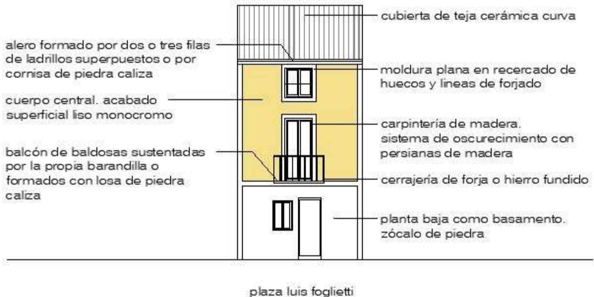
ALZADO. Esquema de los sistemas constructivos característicos del NHT de Santa Faz
